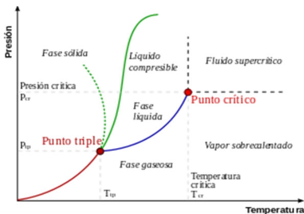
Figura 2: Diagrama de presión-temperatura de los estados del CO 2 Tomado de: http://commons.wikimedia.org/wiki/File:phase-diag-es.svg
