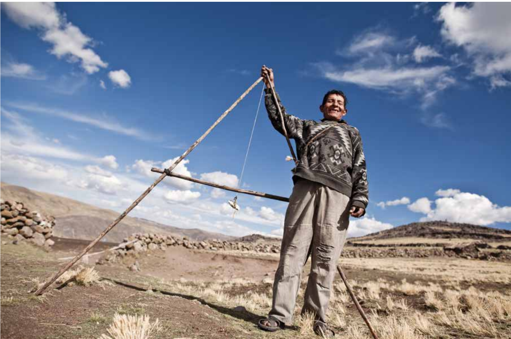
"Nivel A" Un agricultor de la comunidad de Kilcata muestra el funcionamiento del "Miguel Cholo", una antigua y olvidada herramienta que construida con tres palos, una pita y una piedra, que hace de plomada, les ha permitido una mejor conducción del agua, evitando la erosión de sus terrenos por causa de la escorrenría.
