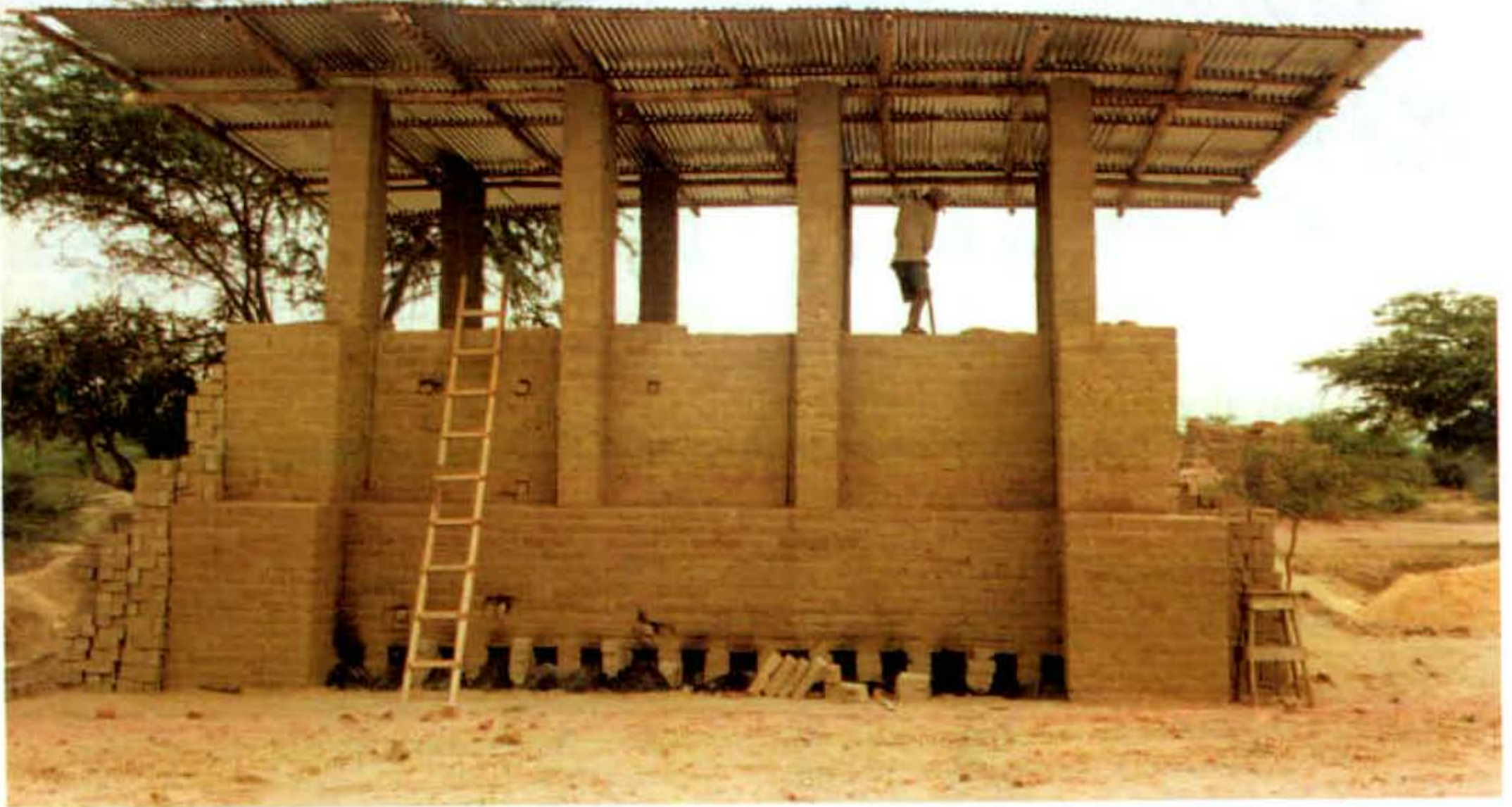
■ Horno de pruebas, completamente cargado y listo para iniciar la quema.
