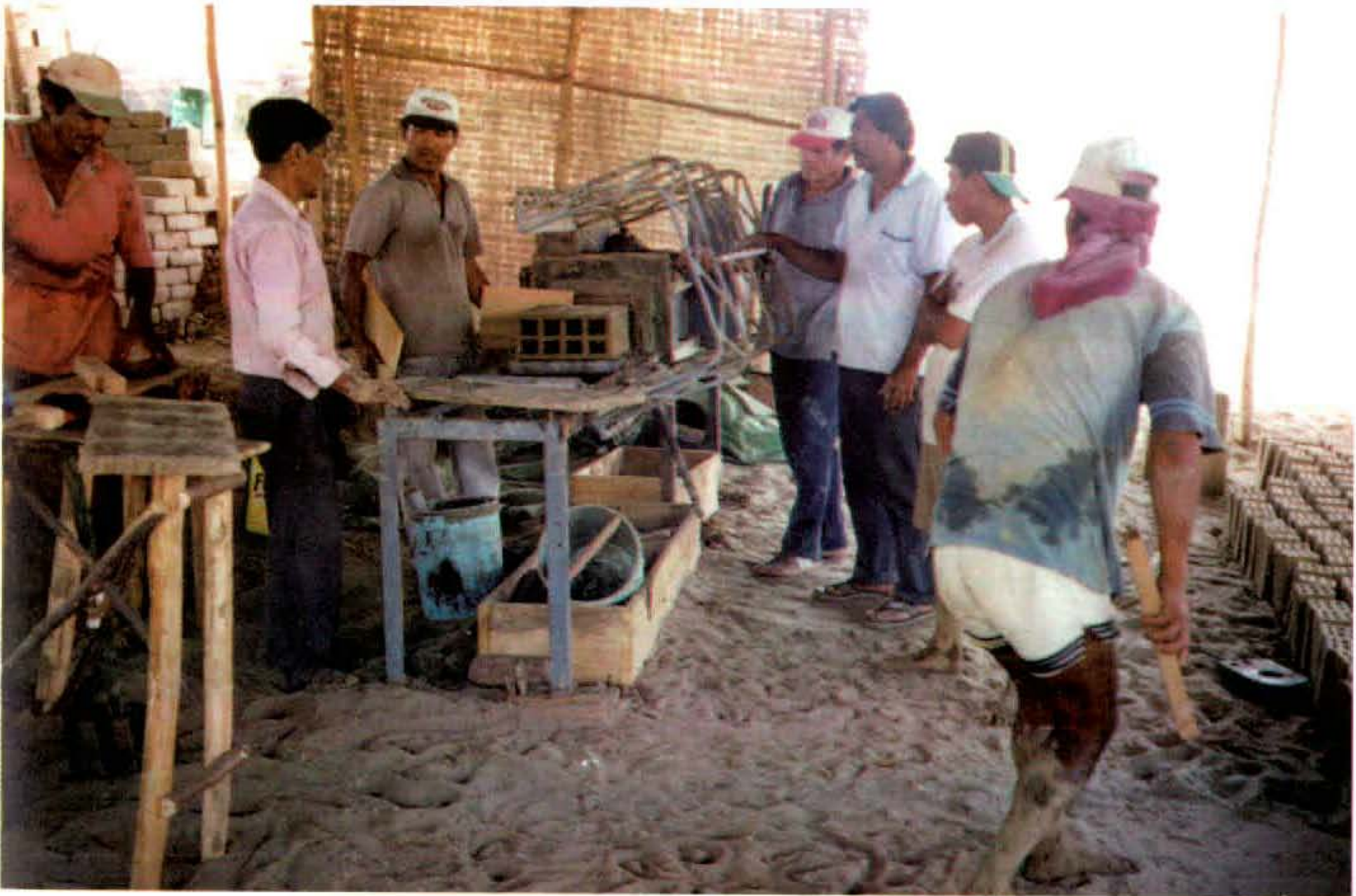
■ Se introdujeron equipos para la mezcla y extrusión procedentes del departamento de San Martín.
