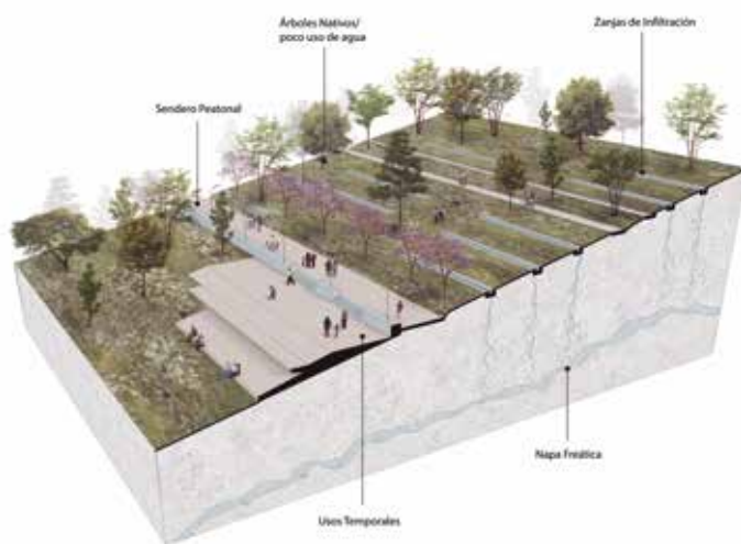
IMAGEN 32. ZANJA DE INFILTRACIÓN EN ZONA PAISAJÍSTICA
