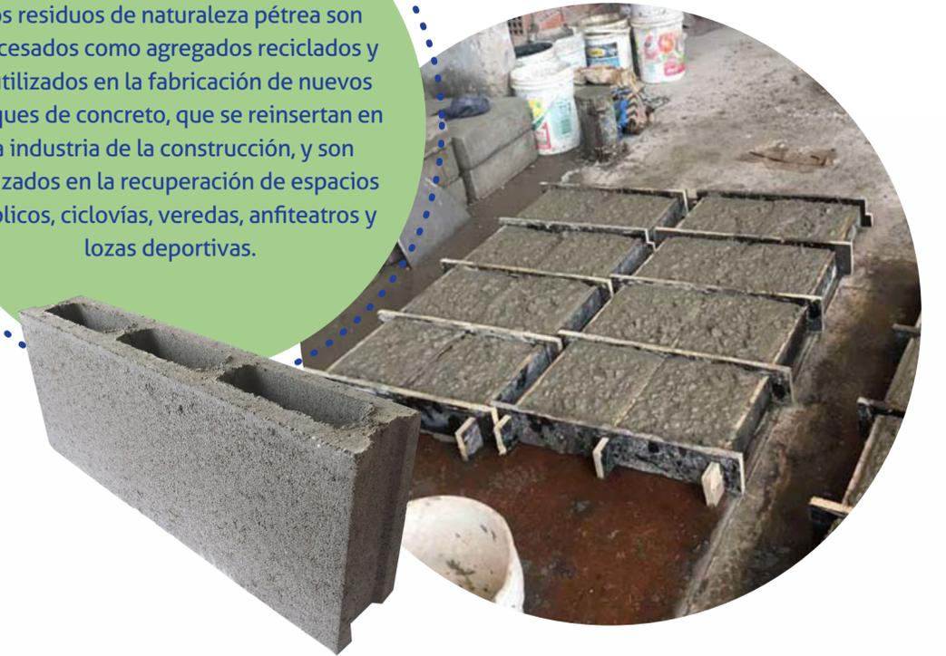
“ Iniciamos con la segregación de papel, cartón, metales, madera y plásticos, pero ante la problemática de la disposición de los residuos de la construcción, incorporamos su recuperación para producir bloques de concreto. ”
